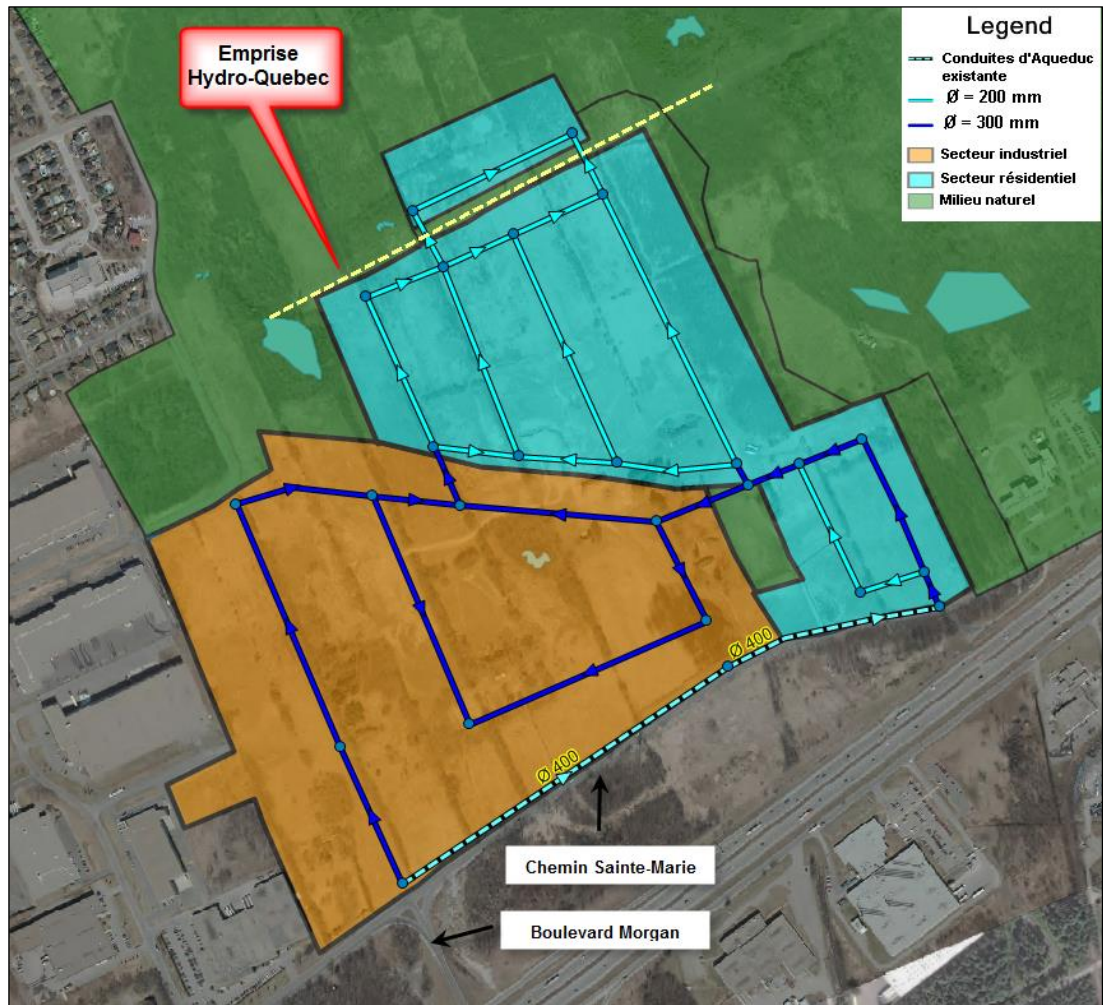
Figure 3 : Représentation schématique du réseau d'eau potable proposé
