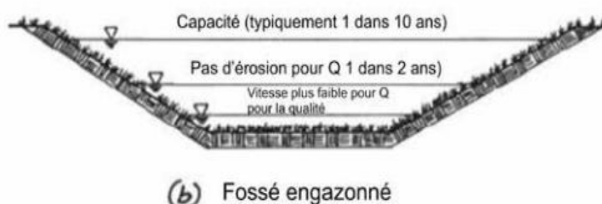
Figure 9 : Section transversale type d'un fossé engazonné
